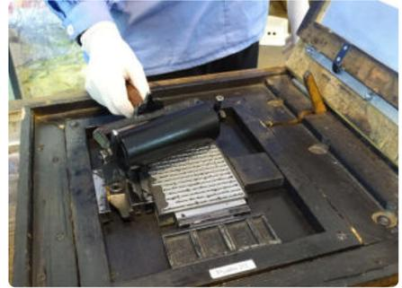
Die Druckplatte wird eingefärbt
